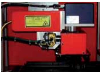
Optisches Lesesystem zur Qualitätsprüfung
